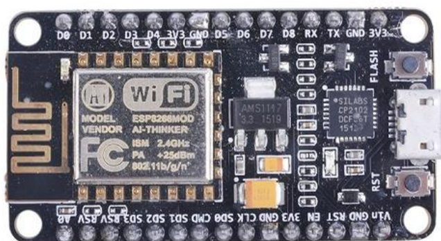
Figura 2 – Vista frontal de um módulo nodeMCU ESP8266 V2. (NODEMCU, 2021)
