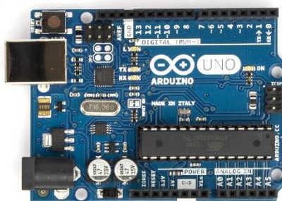
Figura 1 – Vista frontal de um Arduino UNO R3. (ARDUINO, 2021)
