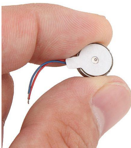
Figura 4 – Motor de vibração 1027. (FELIPEFLOP, 2021)
